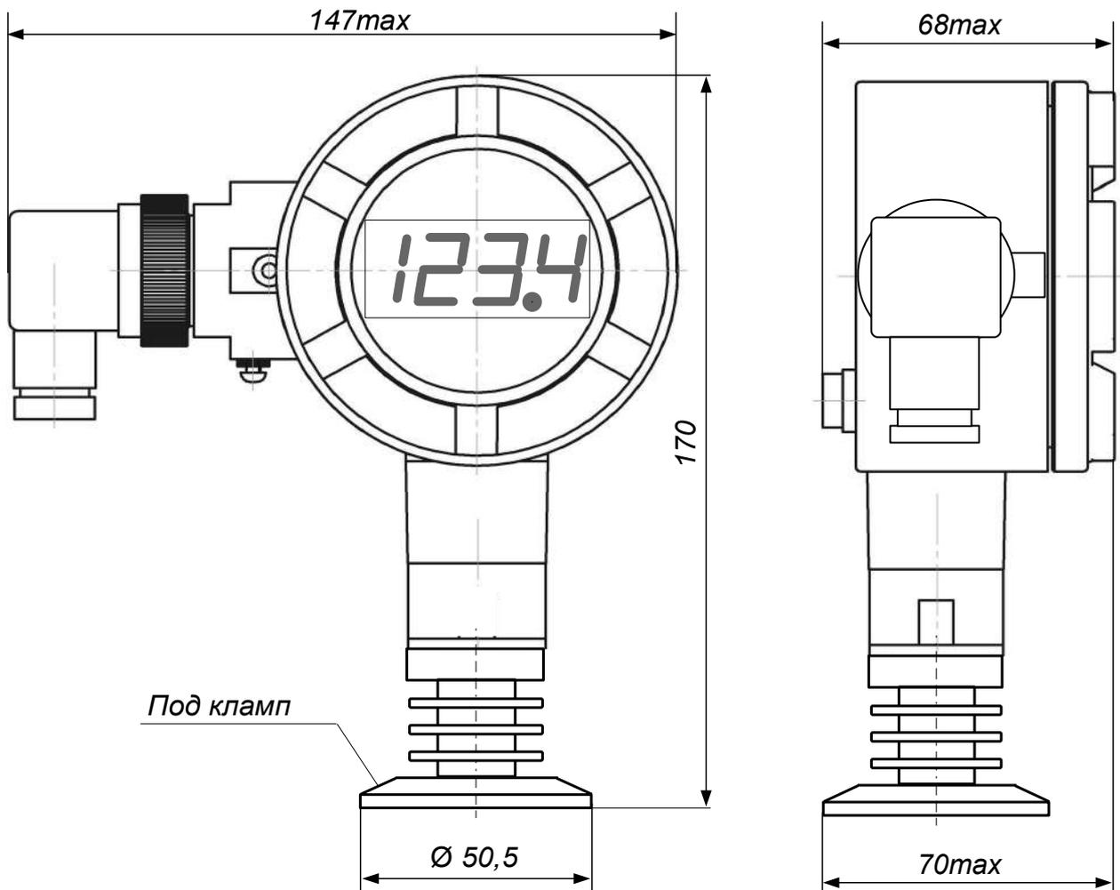
Рисунок А.4 - Габаритные и монтажные размеры ПД-1Ц.В.И.ИЗ.КЛ.ГР с открытой мембраной из нержавеющей стали под кламп (Tri-clamp DN=1 1/2")
