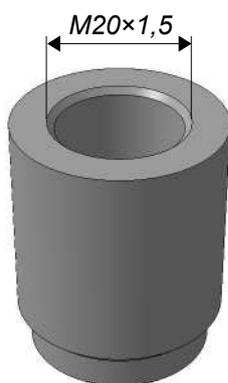
Рисунок 3.4 - Бобышка сварная для крепежа преобразователя ПД-1Ц с помощью шулера М20×1,5
