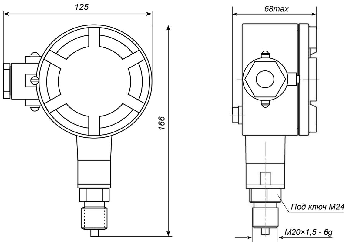
Рисунок А.1 - Габаритные размеры РД-1Ц.В.х.хх.М.КВ со штуцером М20×1,5 с трубкой
