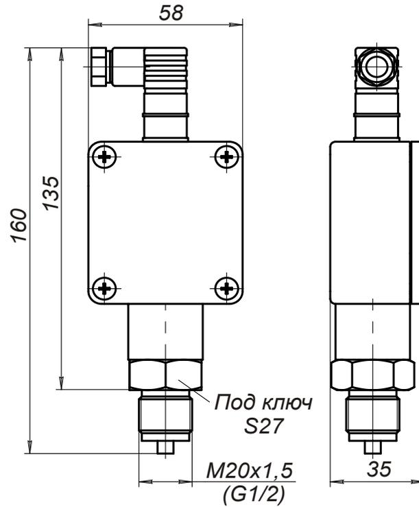
Рисунок А.5 - Габариты ПД-1Ц.П.0.И1.М(Г).ГР со штуцером М20×1,5 с трубкой
