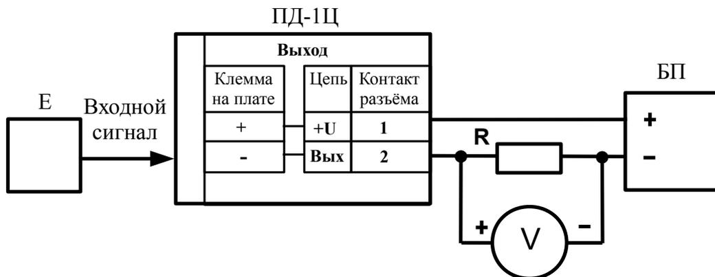
Рисунок Г.1 - Схема подключения модификаций ПД-1Ц с индикатором
