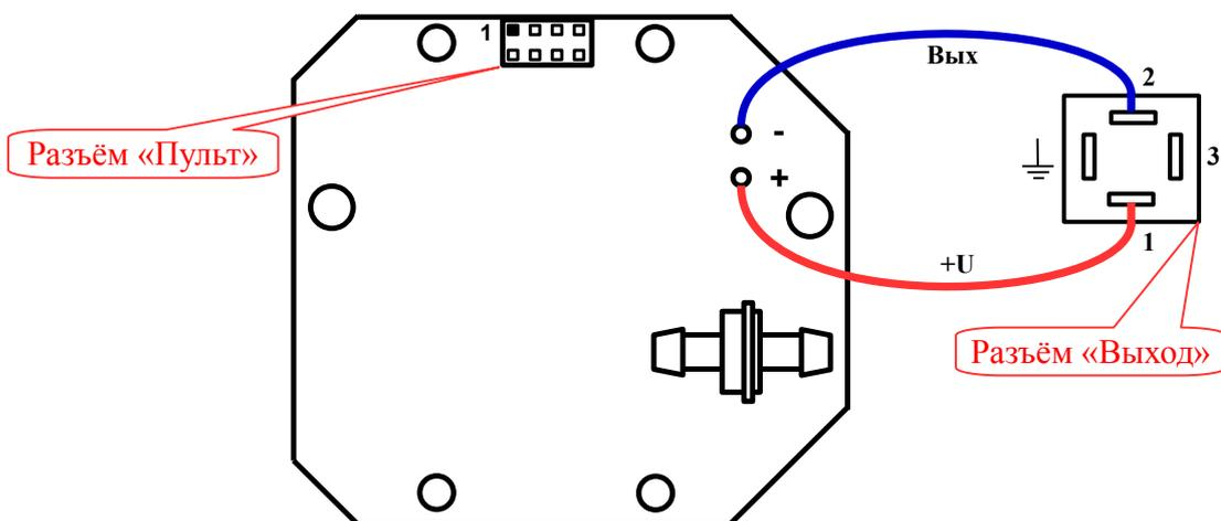
Рисунок Б.2 - Соединение платы входа (нижняя) и внешнего разъёма «Выход» в преобразователе ПД-1Ц.В.И
