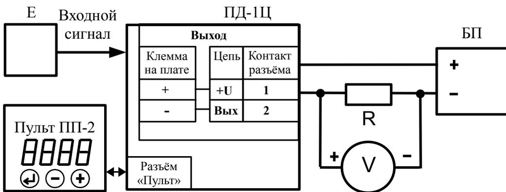
Рисунок Г.2 - Схема подключения с пультом для модификаций ПД-1Ц без индикатора
