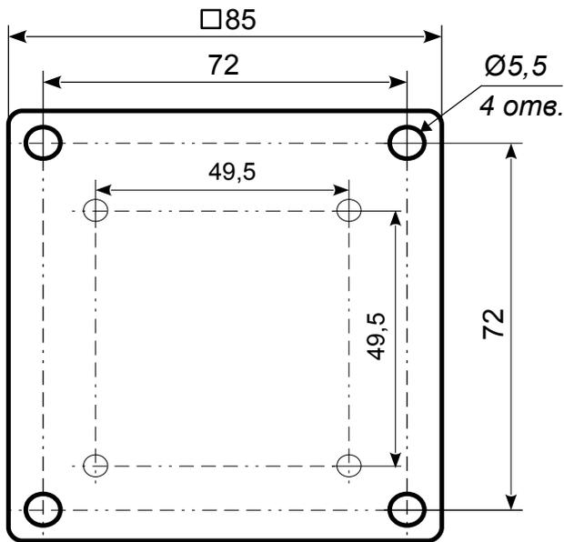
Рисунок 3.1 - Пластина крепёжная для монтажа преобразователя ПД-1Ц.В на стену
