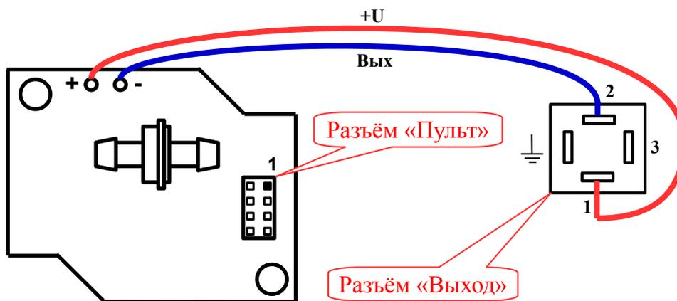
Рисунок Б.3 - Соединение платы и внешнего разъёма «Выход» в преобразователе ПД-1Ц.П
