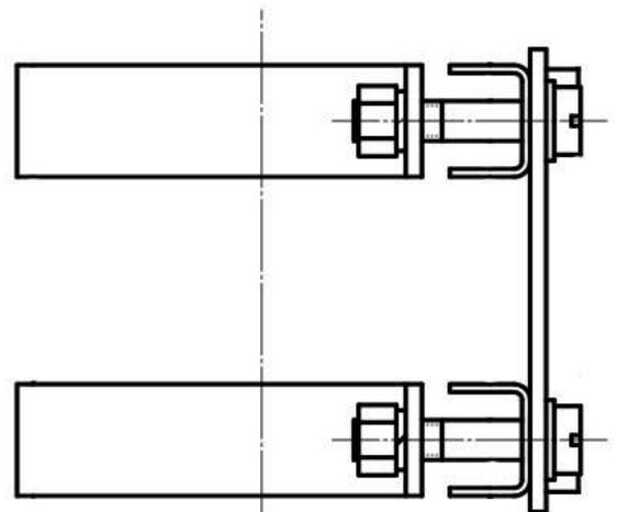
Рисунок 3.3 - Комплект крепежа преобразователя ПД-1Ц.П на трубу с наружным диаметром 57 мм
