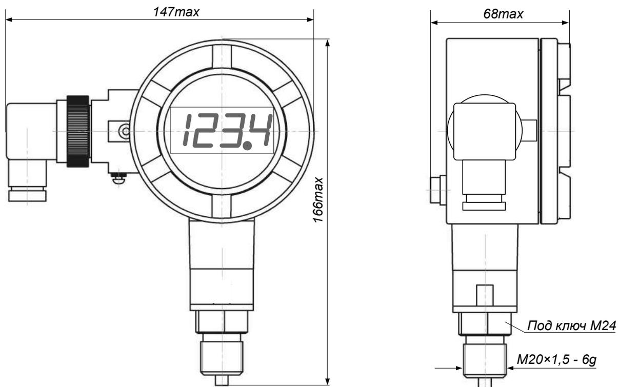
Рисунок А.2 - Габаритные размеры РД-1Ц.В.И.хх.М.ГР со штуцером М20×1,5 с трубкой
