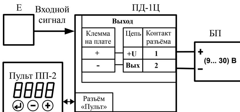
Рисунок Д.1 - Схема соединений для программирования ПД-1Ц
